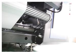
配置张力系统使打印过程走料更稳定，打印效率提升
