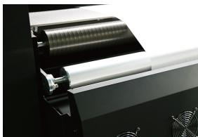
螺旋分布进纸系统通过减少上料时材料褶皱以及增加主动轴的摩擦力，确保各类材料步进时的顺畅；
