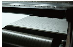
导气槽蜂窝平台，走料平稳，纸张不易起鼓，提升输出品质，平台校准调节更便捷
